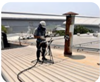
รูปภาพการตรวจวัด คุณภาพอากาศที่ปลายปล่อง
